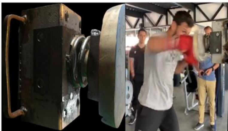
Fig. 1. - Estructura metálica para la medición de la Fuerza máxima del golpe recto
